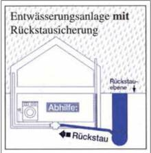
Vor allem bei sommerlichen Wolkenbrüchen kann die Kanalisation die Wassermassen nicht immer vollständig aufnehmen und ableiten. Der Wasserspiegel kann dann in einzelnen Kanalstrecken oder Netzteilen, in Einstiegschächten, in den Hausanschlusskanälen und den Fallrohrleitungen bis zur Rückstauebene (meist Höhe der Straßenoberkante) ansteigen.
