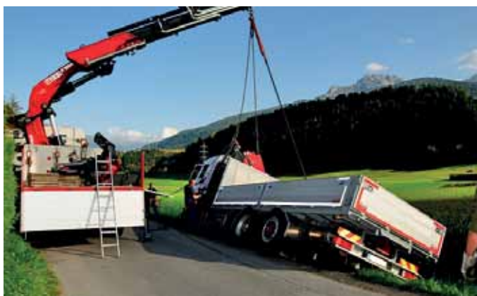
Mittels Schwerlastkran wurde der LKW wieder aufgerichtet.
